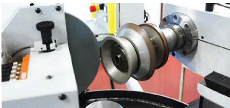
Figura 7: Perfilado en una máquina externa
