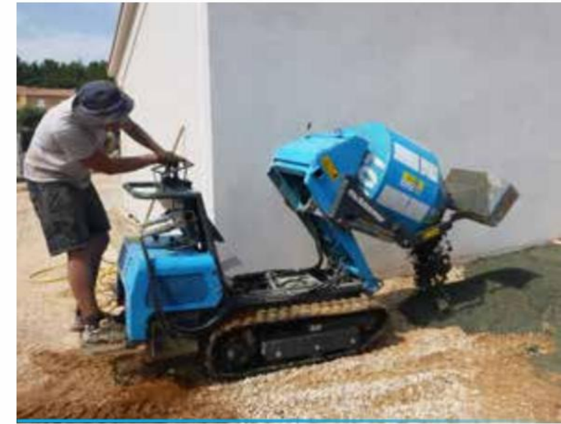
Versión con hormigonera, capacidad productiva 180 l Versión hormigonera, 180 l de hormigón revocado.
