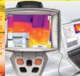
Imagen termográfica y real al mismo tiempo / software para PC, para analizar y representar los datos en tabla o gráfica
