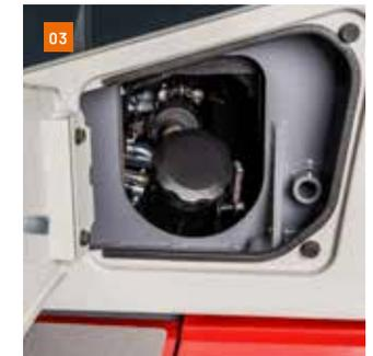
**03** Tapa de registro adicional para un acceso óptimo a la bomba de repostar y la tapa del depósito
