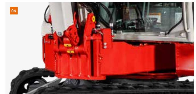
**04** Sistema de desplazamiento lateral del brazo, patentado por Takeuchi, extremadamente robusto
