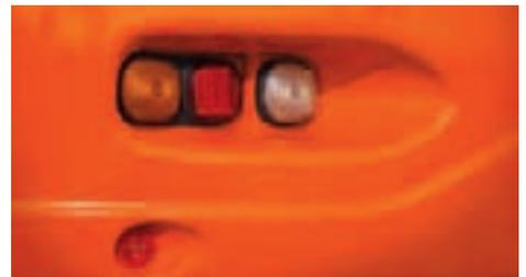
**Luces de parada por fotodiodos (LED)**
