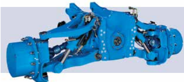
EJE MODELO 970 SPICER PARA TRACTORES DE ALTA VELOCIDAD. El eje Modelo 970 Spicer es el más grande de los ejes de Dana diseñados para tractores agrícolas de 175 a 265 kW en uso continuo en altas velocidades.
