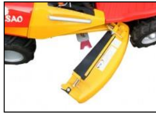
Corte rotativo mediante transmisión por correa
