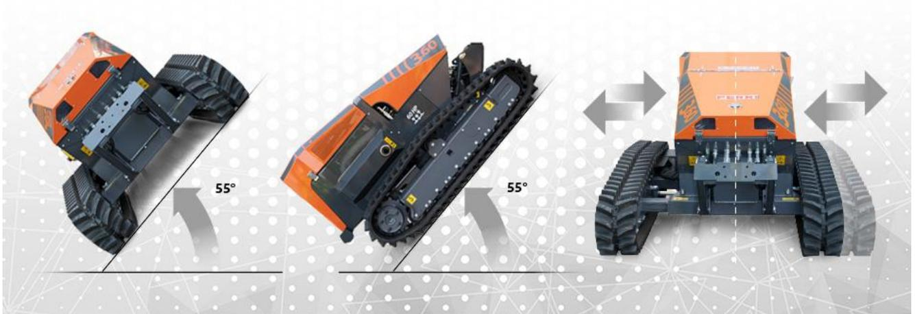
El innovador diseño a baricentro bajo permite trabajar con una inclinación de hasta 55°. Gracias a una distribución óptima del peso y a un centro de gravedad bajo, la iCUT es capaz de operar en ángulos de pendiente en todas las direcciones de hasta 55°, proporcionando un agarre y una tracción óptimos en todas las condiciones de trabajo
