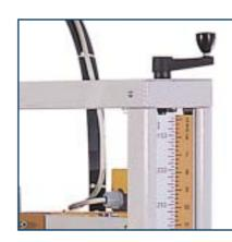
El modelo Reisotape M es de regulación manual para series de cajas de igual medida. El modelo Reisotape A se regula automaticamente para precintar cajas de dimensiones variadas.
