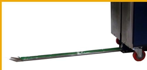
La máquina dispone de una lanza telescópica para pasar el fleje por debajo del palet.
