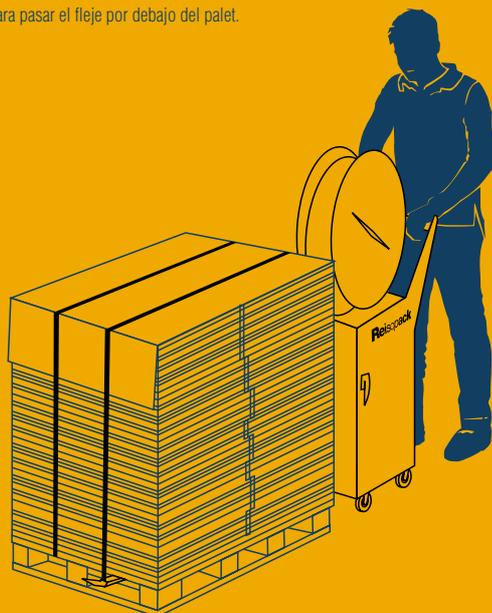
La máquina se desplaza manualmente hacia el palet evitando mover la carga antes del flejado.
