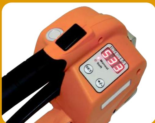
Pantalla digital con parámetros siempre visibles (tensión, tiempo de soldadura, nivel de carga de la batería).
