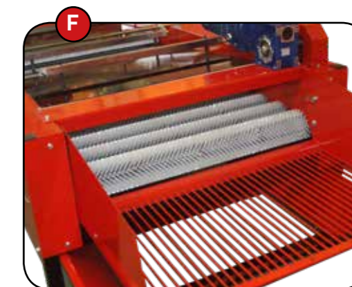
F. Решетка на выходе просеивает очищенный чеснок, отделяя остатки грунта перед выгрузкой продукта в контейнер.
