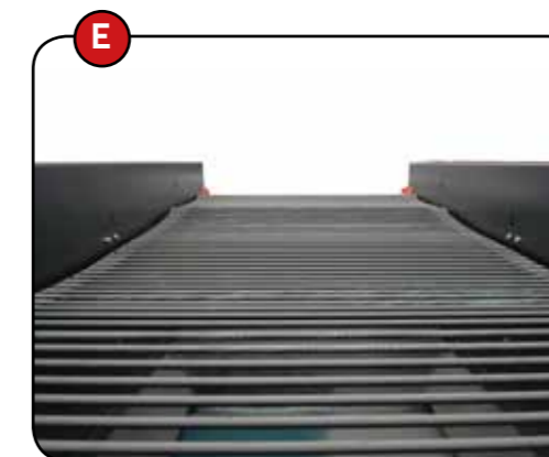
Е. Рабочая площадь очистки 970 мм на 2050 мм позволяет достигать производительность до 8 тонн/час с высокой способностью отделения и удаления отходов.
