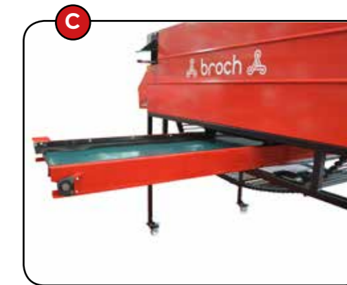
С. Грязь с транспортера поступает на ленту для сбора и вывода отходов и автоматически выгружается в контейнер.
