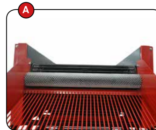
А. Система пруткового транспортера, с щёткой и решёткой гриль на выходе эффективно отделяет и просеивает остатки грунта, улучшая процесс сушки.
