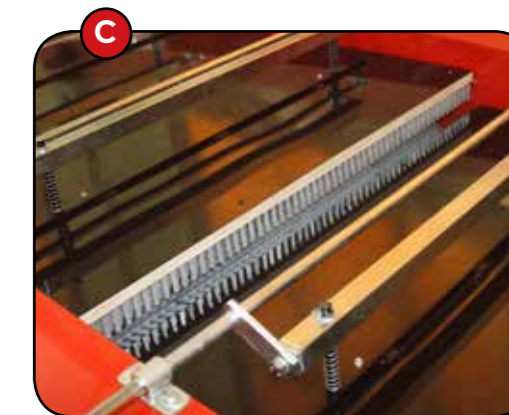
C. Две плиты щеток снизу и сверху с двойной регулировкой позволяют контролировать интенсивность очистки
