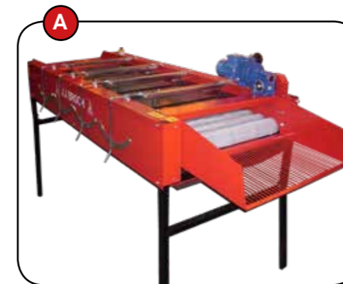
A. Щетки с рабочей площадью в 3 метра сверху и снизу. Эффективное удаление грунта и поверхностной загрязненной шелухи с головок чеснока.
