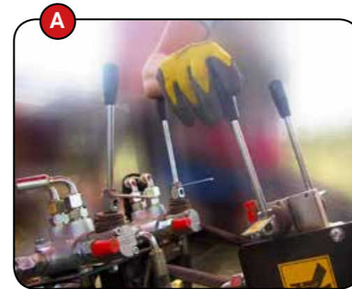
A. Гидравлический привод
