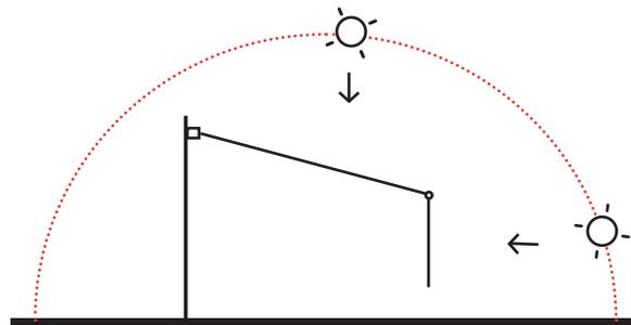
El sistema MODULBOX-400 permite incorporar el SOMBREX en todas las opciones de configuración. Este faldón enrollable optimiza las prestaciones del producto ya que aporta mayor protección solar incluso cuando la posición del sol es baja en el horizonte.
