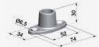
Montaje varilla - cable suelo
