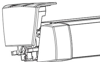
Permite colgar el grupo de enrollado en los soportes laterales del MATICBOX S-350 sin que sea necesario soportar el peso del toldo mientras se asegura la instalación. El conjunto se mantiene por sí solo en su posición durante las operaciones de la sujeción definitiva.
