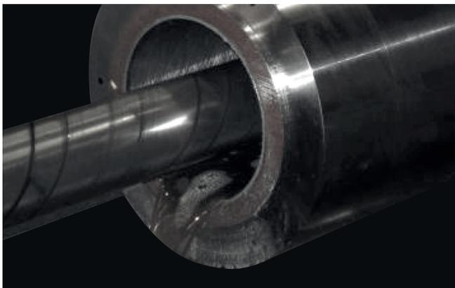
Aumento del diámetro interno mediante lapeado.
