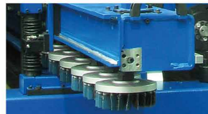
XVS Ø 130 mm con insertos abrasivos para desbarbar y redondear cantos
