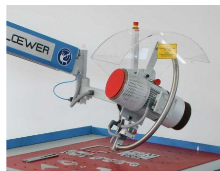
Cabezal inclinable de 180° para acceso rápido a herramientas de desbarbado y fresado de bordes
