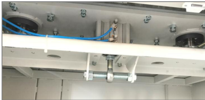
Los imanes se activarán en posición superior y se desactivarán en posición inferior.
