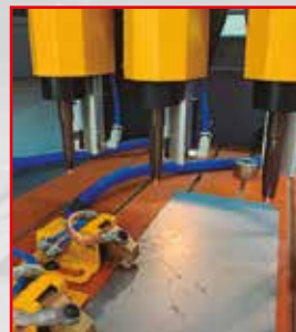
Cabezales directos, no aptos para galvanizado.
