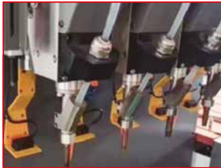
Detector de presencia del perno (Triple control).
