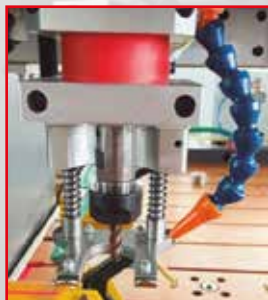
Cabezal de fresado para eliminar el zinc del galvanizado.
