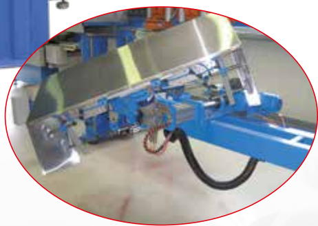
Desbarbadora pulidora Kuhlmeier modelo PZM automática, para piezas de grandes dimensiones.
