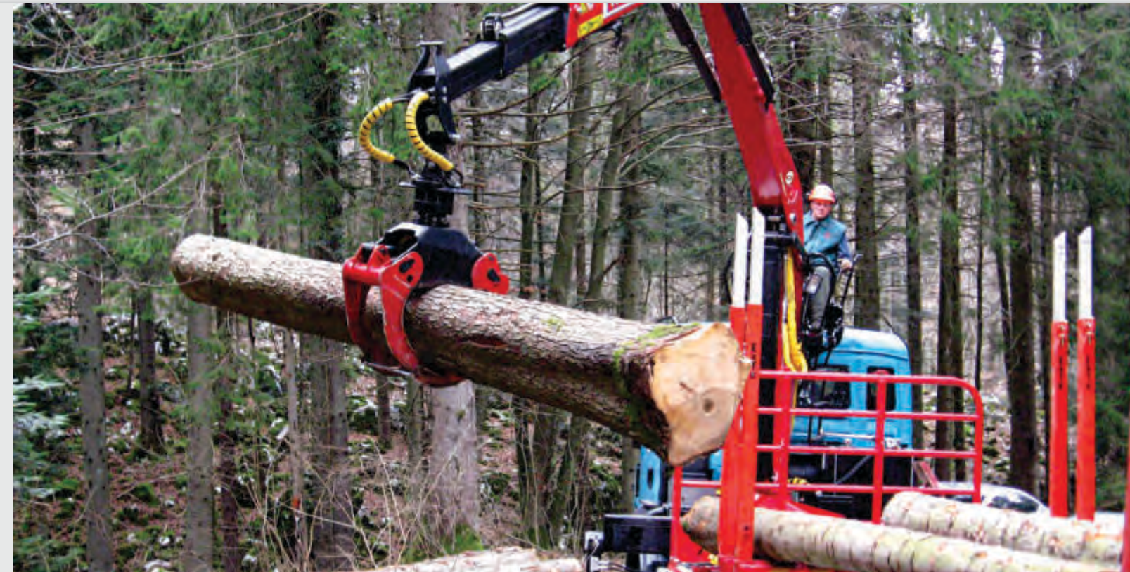
Alto nivel de seguridad garantizada por la parte inferior de la columna en fundición
