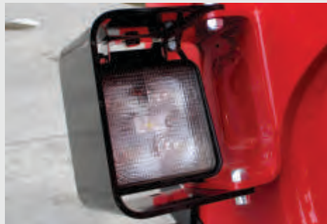
2 reflectores LED en el brazo secundario
