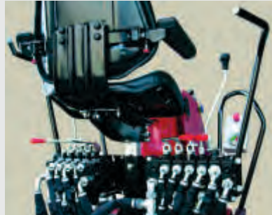
Mandos ergonómicos - 2 palancas laterales en cruz y 2 pedales
