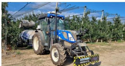
El proyecto desarrolla un sistema autónomo completo, basado en maquinaria agrícola existente y estándares del sector, preparado para pruebas comerciales a gran escala. Esta solución se ha demostrado en explotaciones piloto de cuatro países europeos, y combina tres elementos clave: vehículos autónomos, herramientas inteligentes y un sistema de gestión centralizado, que planifica, asigna y supervisa las tareas agrícolas en tiempo real.
