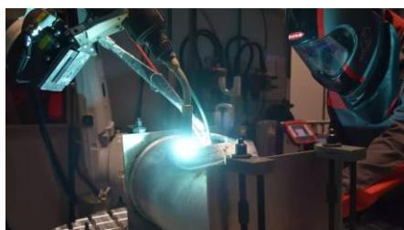
También ofrece ventajas con respecto a las piezas de recambio, la construcción de prototipos y la producción de pequeñas series. En EE. UU ya hay normas para la impresión 3D con metal, y en Europa se están elaborando para los depósitos a presión no sometidos a acción de llama fabricados de forma aditiva. Linde Engineering, MIGAL.CO, TÜV SÜD Industrie Service GmbH y Fronius están trabajando en primera línea para dar el impulso definitivo a esta variante de producción basada en soldadura por arco.
