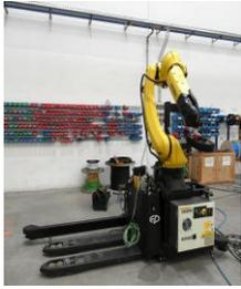
Atlas Robots ha dado respuesta a esta pregunta con el lanzamiento de su más reciente innovación: un sistema que combina la precisión de un robot paletizador con la movilidad de un AGV, ofreciendo una solución revolucionaria para las plataformas logísticas.
