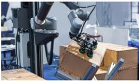
Como su nombre indica, las tareas de paletizado y despaletizado se centran en la manipulación y disposición de productos sobre o desde palés. El paletizado implica la colocación ordenada y segura de productos en estas estructuras, mientras que el despaletizado se refiere a la operación inversa, donde los productos se retiran de los palés de manera precisa y eficiente.
