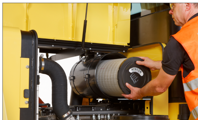
Las alas de gaviota proporcionan un fácil acceso para realizar comprobaciones de servicio rápidas
