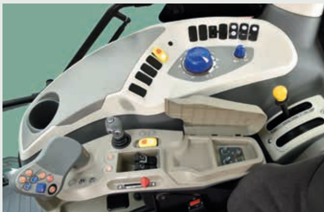
El interior de la cabina en la versión VT-Drive : los mandos del tractor están integrados en el apoyabrazos derecho del asiento del conductor.
