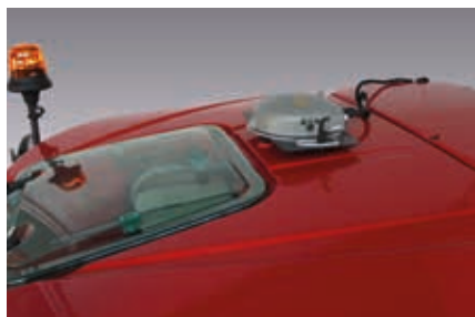
La antena satelital instalada sobre el techo de la cabina recibe la señal GPS.
