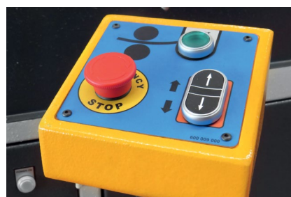
Comando dos rolos hidráulicos
