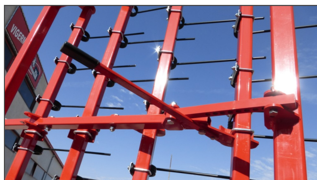
Sistema de púas abatibles y con tope mecánico para posición.
