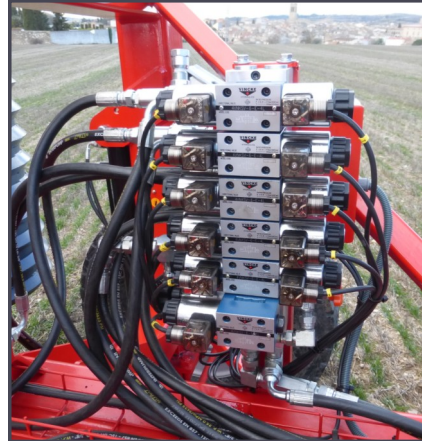
Equipo válvulas línea sensora vía radio opcional
