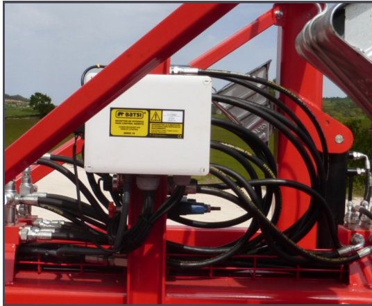
Equipo válvulas línea sensora vía radio opcional
