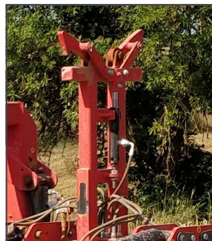
Cierre hidráulico de seguridad
