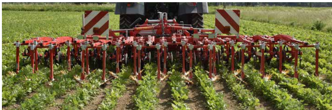
Un muelle de pretensión, asegura una calidad de trabajo uniforme de los escardadores de dedos
