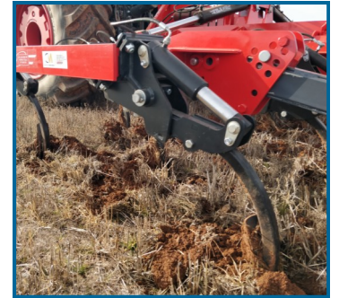
Conjunto brazo hidroneumático
