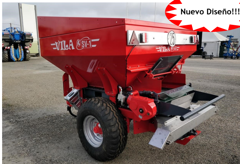
SV-1 con funcionamiento hidráulico y esparcidor de doble discos INOX
