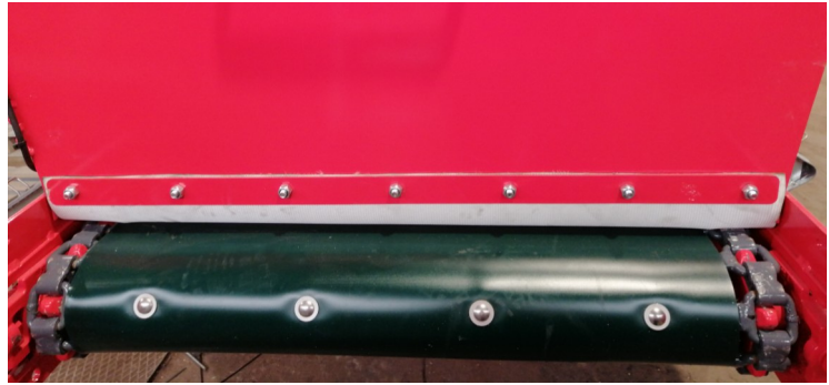
Con banda de goma y cadena Para abono granulado o mineral
