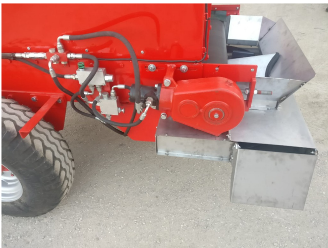
SV-3 con reductor y motor hidráulico con válvulas de regulación
