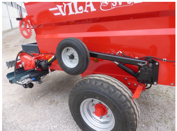
SV-3 con reductor y toma de fuerza. Funcionamiento mecánico para reparto a la velocidad de la máquina
