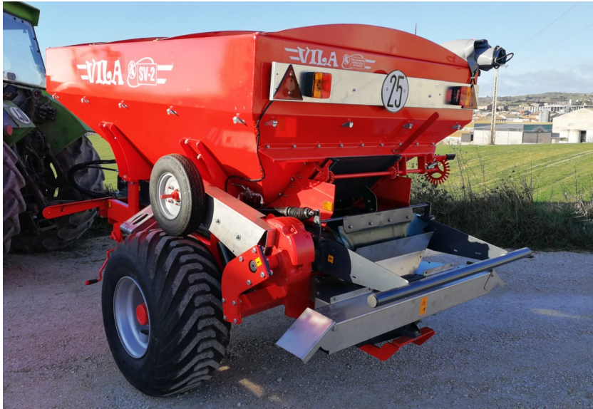
SV-2 con esparcidor de doble disco INOX y orientador de abono INOX
