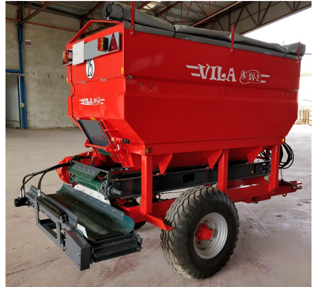
SV-2 MINI con cinta desplazable hidráulica a la derecha y rodillo lanzador fijo
