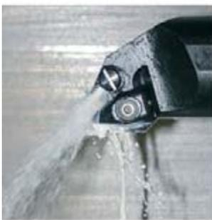
Una boquilla integrada asegurará la refrigeración y la evacuación segura de las virutas.
