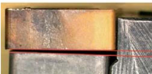
Un levantamiento de la plaquita de su alojamiento, un problema frecuente del sistema de sujeción por palanca con cortes pesados será evitado por completo.
