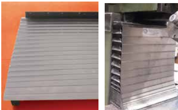
Ejemplos de fuelles con láminas de inoxidable recomendado para zonas de viruta caliente
