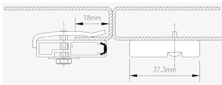
Fig 1: 743 000 abrazadera de sujeción y tornillo autorroscante
