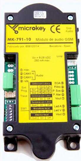
El MK791 es un módulo de audio digital para teléfono de emergencia, instalado tras la botonera (COP), que funciona cuando se conecta a la plataforma de comunicación digital MK775.
