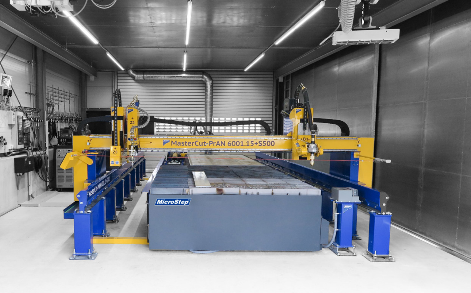
MasterCut con guías lineales en el eje X y carril lateral para el corte de tubos
