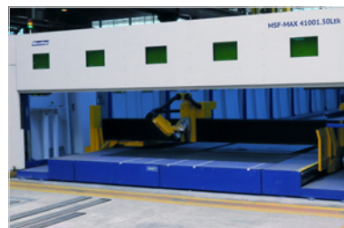
Cabezal de biselado con láser de fibra hasta 45°
