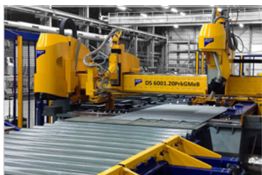
Línea automatizada de procesamiento de estructuras de acero
