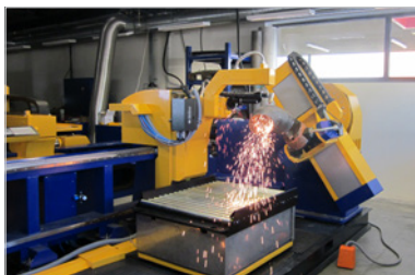
Preparación de soldadura para codos con el accesorio ElbowCut
