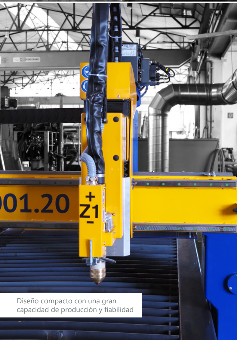
Cabezal de biselado en 3D de altas prestaciones hasta 50°
