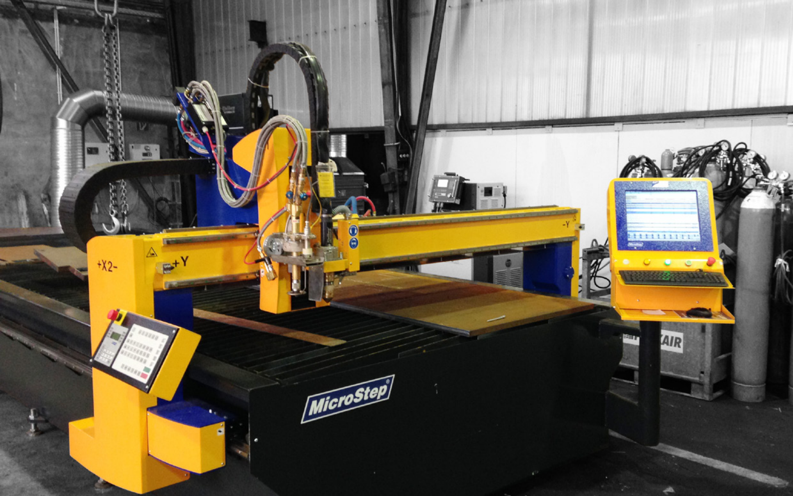
MasterCut Compact con equipo de plasma de alta definición y oxicorte
