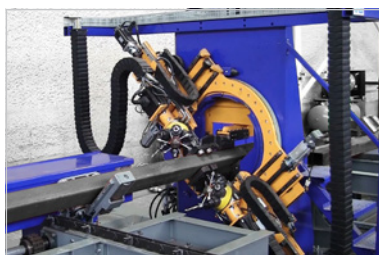
DS-B: Doble mecanizado y marcado totalmente automático
