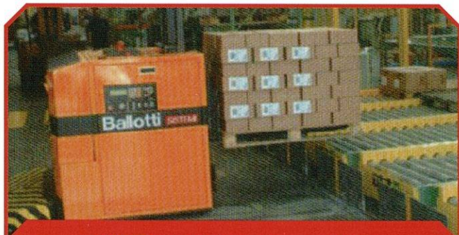
AGV interconectado con convoyadores
