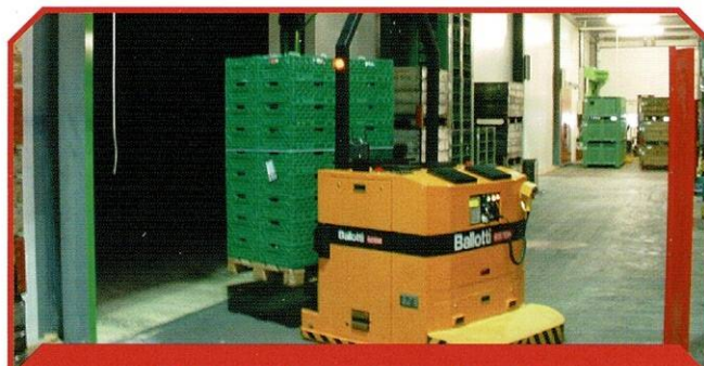
AGV entrando en cámara frigorífica
