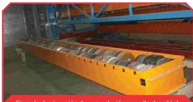
Ejemplo de ejecución de una solución con alta densidad de almacenamiento de matrices en la unidad de carga.
