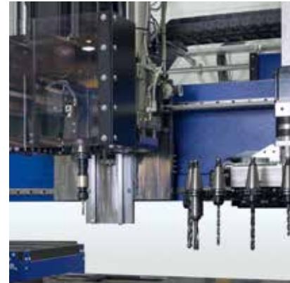
Cargador móvil con 12 herramientas de roscado 12 tool mobile changer with tapping tool
