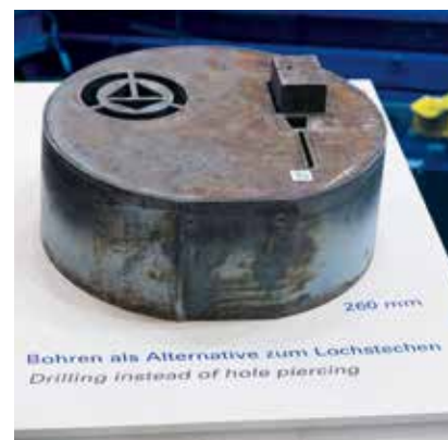
Perforación profunda para los agujeros de partida para el proceso de corte. Deep drill for starting holes for the cutting process
