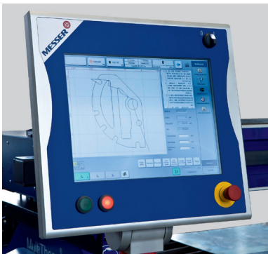
El moderno CNC Global Control ofrece un uso más fácil e intuitivo para el operario.
