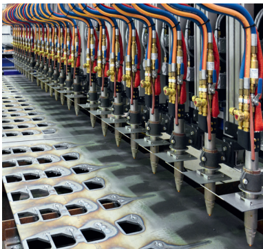
La máquina se puede equipar con un máximo de 24 sopletes de oxicorte.
