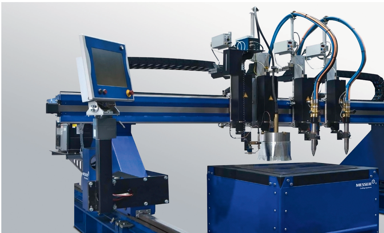
El elevador de la antorcha inteligente SL200 para plasma, permite ciclos de ahorro de tiempo y altas velocidades de movimiento.
