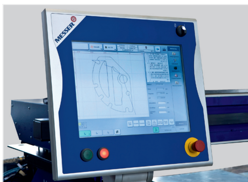
El fácil uso del Global Control acelera la configuración, reduce los errores y los tiempos no productivos.
