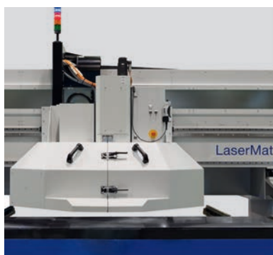
La cubierta protectora a bordo del láser junto con las barreras de luz permiten la carga directa de la grúa, así como la carga y descarga durante la operación de corte.
