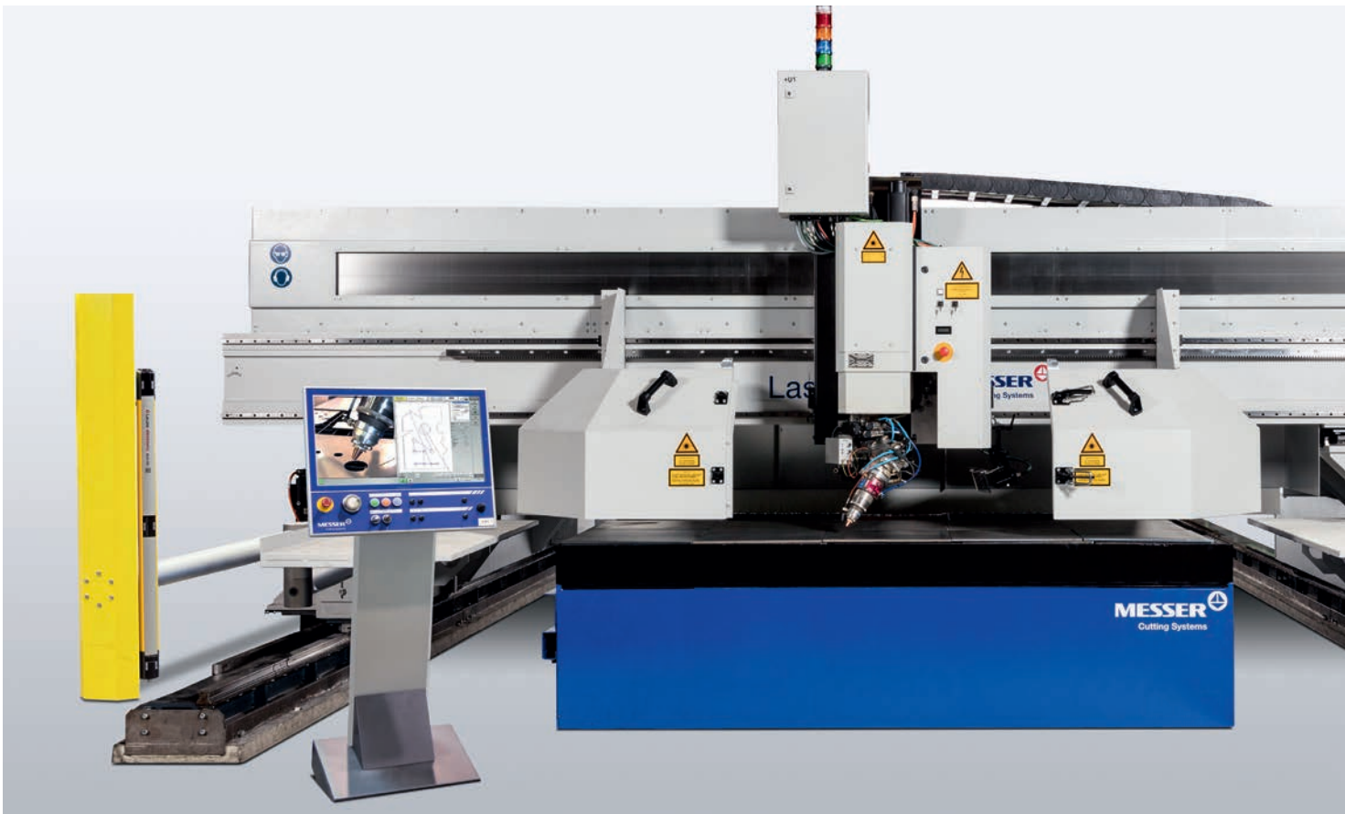
El nuevo Global Control con pantalla táctil de 24" ofrece mucho espacio y una guía clara para el operario que puede configurarse de manera flexible.
