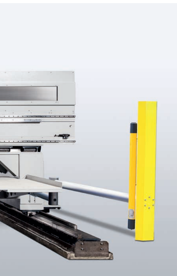
La cubierta protectora a bordo del láser junto con las barreras de luz permiten la carga directa de la grúa, así como la carga y descarga durante la operación de corte.
