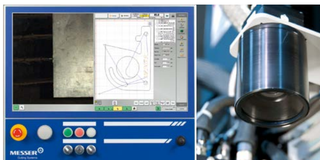
La cámara de vídeo (derecha) permite una alineación de chapa rápida y precisa
