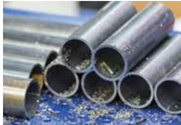
Rebabas en los extremos de los tubos metálicos cortados
