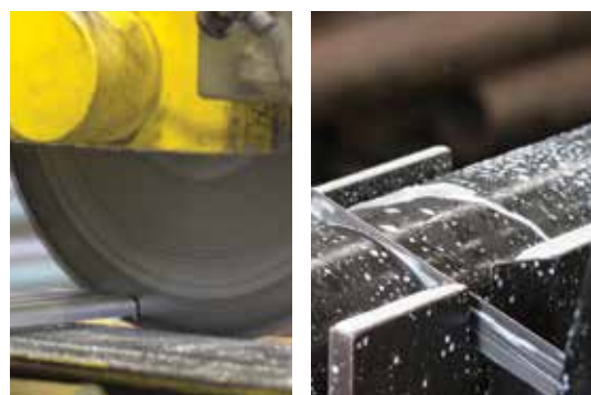
Ejemplos de cómo se cortan los tubos metálicos
