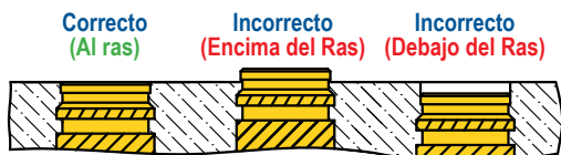
La parte superior del Inserto debe ser instalada lo más cerca posible de la superficie del plástico.
