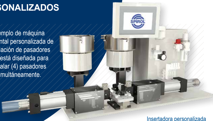
Insertadora personalizada de pasadores cu druple
