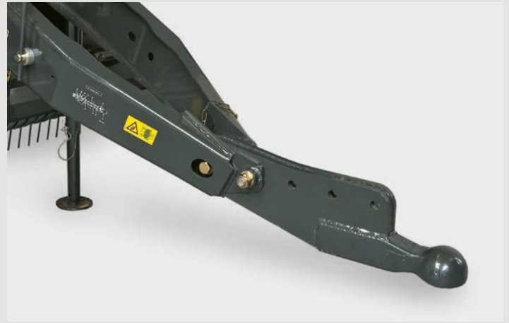
VARIAS OPCIONES DE ENGANCHE, INCLUIDO UN ACOPLAMIENTO MEDIANTE BOLA
