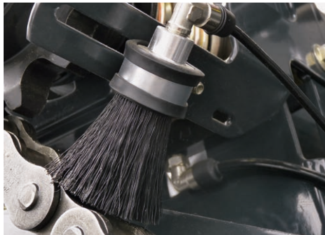
SISTEMA DE LUBRICACIÓN DE CADENAS BEKA MAX (DE SERIE)
