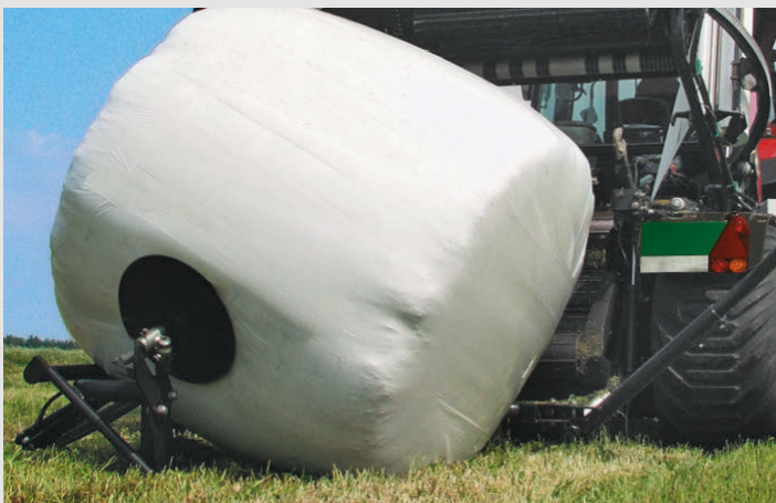
VOLTEADOR DE PACAS, DESCARGANDO LA PACA SOBRE SU LADO PLANO
