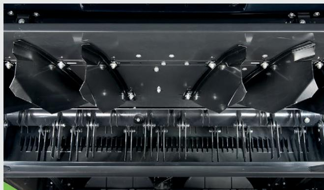
↑ Picador de paja: para facilitar aún más la distribución del material, el picador de paja se puede equipar con un sistema de regulación eléctrica de los deflectores que adecua el esparcimiento a las condiciones ambientales y se acciona directamente desde la cabina.
