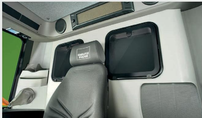
↑ Control visual de la tolva. Una doble ventana de la cabina permite controlar visualmente el nivel de llenado de la tolva y la calidad del grano recogido.
