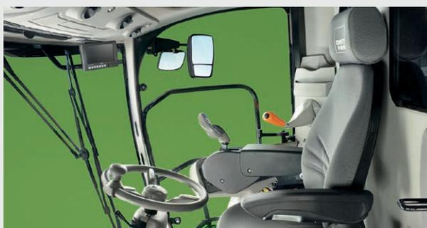
↑ Asiento ergonómico con regulación mecánica o neumática, y columna de dirección ajustable para una posición de conducción cómoda.
