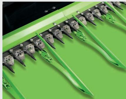
↑ La configuración con las cuchillas alternas reduce el desgaste y garantiza siempre el mejor corte.
