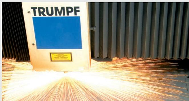
↑ Cada parte de la estructura de la máquina se fabrica con máquinas de corte láser, que a partir del diseño en 3D permiten lograr el componente acabado.
