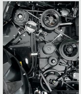
↑ Acceso lateral para las correas. Acceso fácil y rápido. Diseño sencillo de la línea de transmisión.
