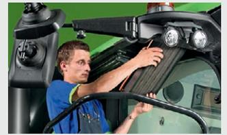
↑ Filtros de la cabina. Sustitución simple y sin necesidad de herramientas de los filtros de la cabina.
