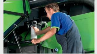
↑ Depósito de combustible y filtros. Zona del depósito de combustible fácil de limpiar y fácil sustitución de los filtros.
