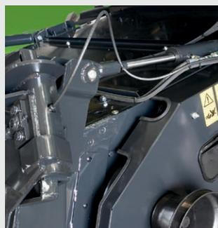
↑ La regulación del ángulo de corte le permite adaptarse perfectamente a las irregularidades del terreno.
