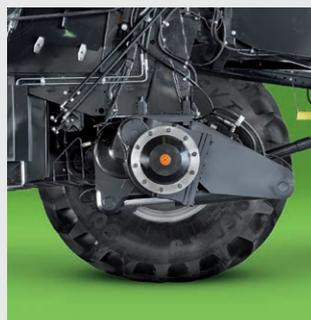
↑ Los ejes, tanto los balance como los estándar, tienen una capacidad de carga de 25 toneladas, lo que permite trabajar con la máxima seguridad incluso en las condiciones más difíciles.
